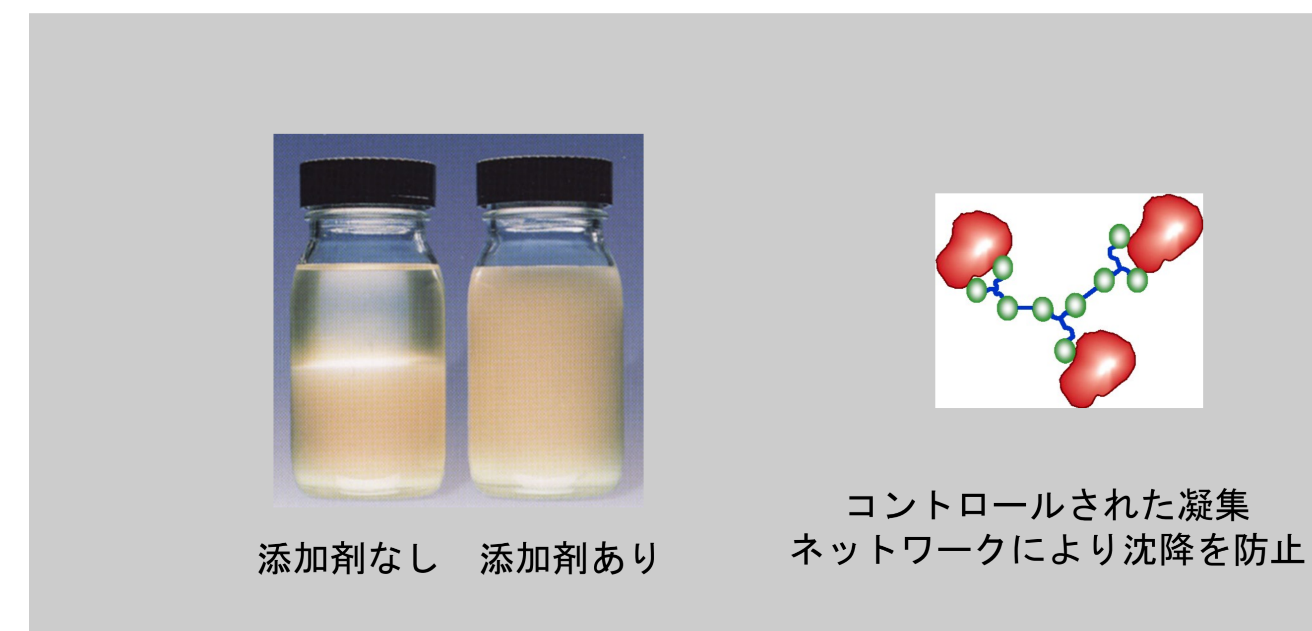
湿潤分散剤による沈降防止の例 (BYK-W 940使用)
