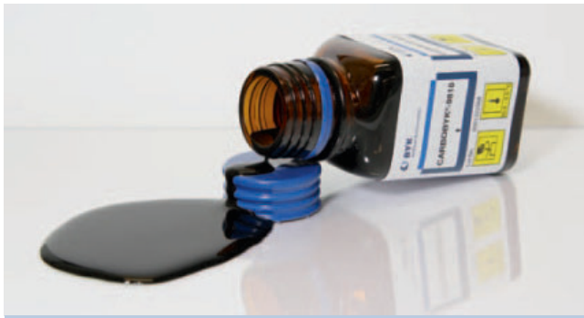
Abbildung 2: Die neue wässrige Dispersion mit acht Gewichtsprozent an mehrwandigen Kohlenstoffnanoröhren verfügt über eine sehr niedrige Viskosität
