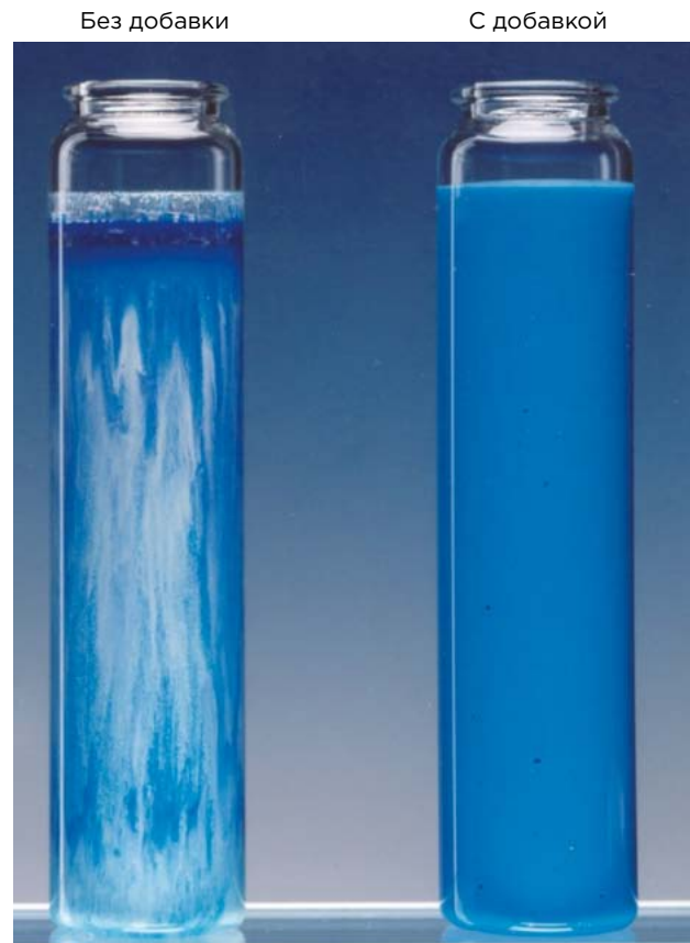
Рисунок 7. Ненасыщенная полиэфирная смола с добавкой для снижения усадки, наполненная и пигментированная.
