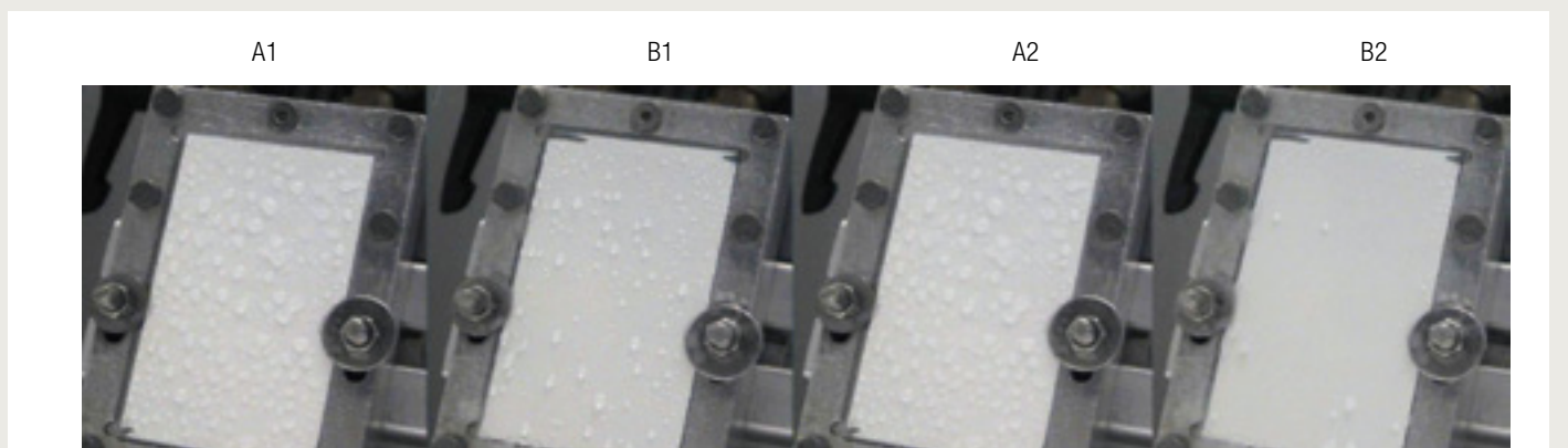
Abb. 10 // Das Oberflächenadditiv verhindert die Eisbildung in Decklacken – sofort nach der Besprenkelung durch Eiswasser (A1 ohne Additiv, B1 mit 2% Additiv) und 5 Minuten nach der Besprenkelung durch Eiswasser (A2 ohne Additiv, B2 mit 2% Additiv)
