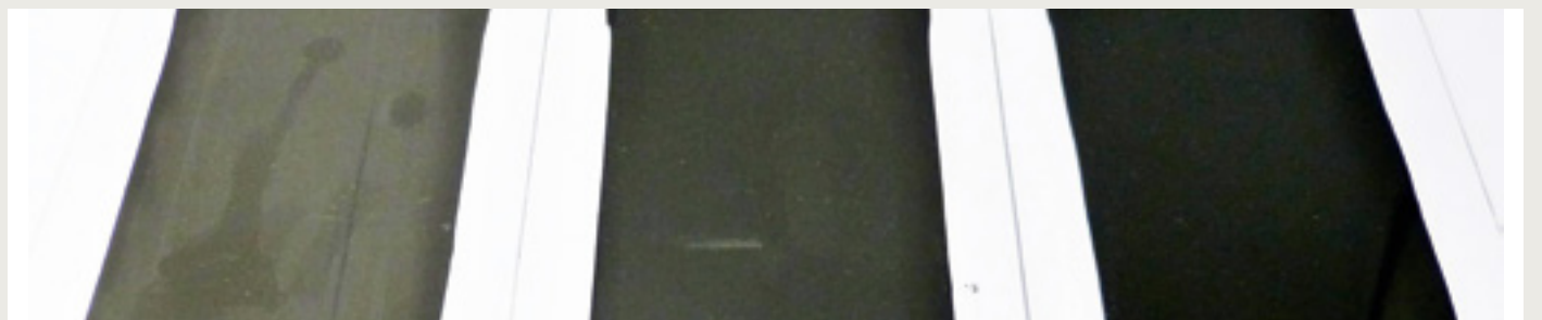
Abb. 9 // 2K-epoxidlackierte Bleche nach der Härtung bei 85% rel. Luftfeuchte. Links: ohne Additiv; Mitte: mit herkömmlichem Silikonadditiv; rechts: mit neuem Additiv.
