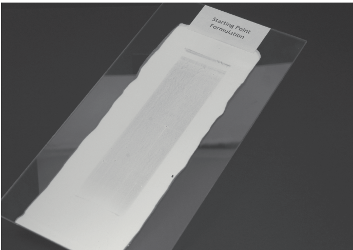
Abb. 5 (unten links) // Lineal zur Einstellung der Belastungsfläche. Abb. 6 (oben rechts) // Probenplatte mit applizierter Wandfarbe ohne Scuff (gut). Abb. 7 (unten rechts) // Probenplatte mit applizierter Wandfarbe und Scuff (schlecht).
