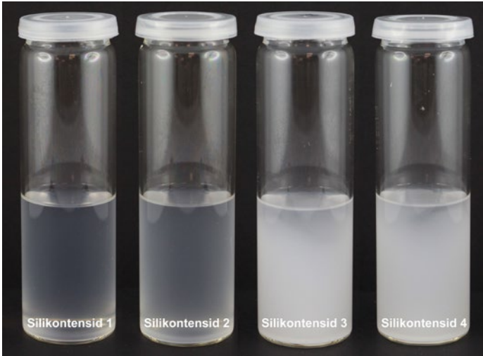
Abb. 3 // Mischbarkeit der neuen Oberflächenadditive in Wasser.
