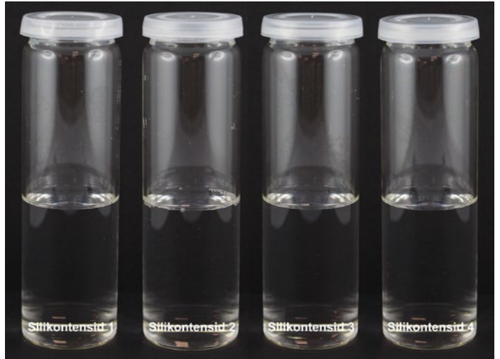
Abb. 4 // Mischbarkeit der neuen Oberflächenadditive in einer Mischung aus Wasser: BG = 80:20.
