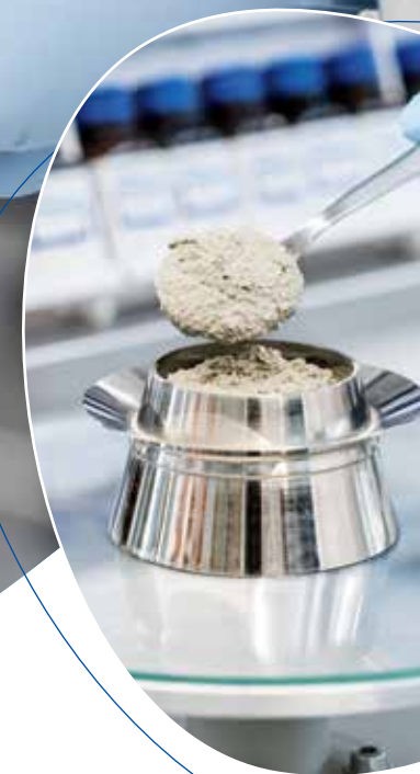
Konsistenzprüfung mit Hägermann-Rütteltisch
