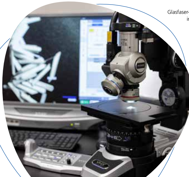
Mikroskop zur Beurteilung von Fasern
