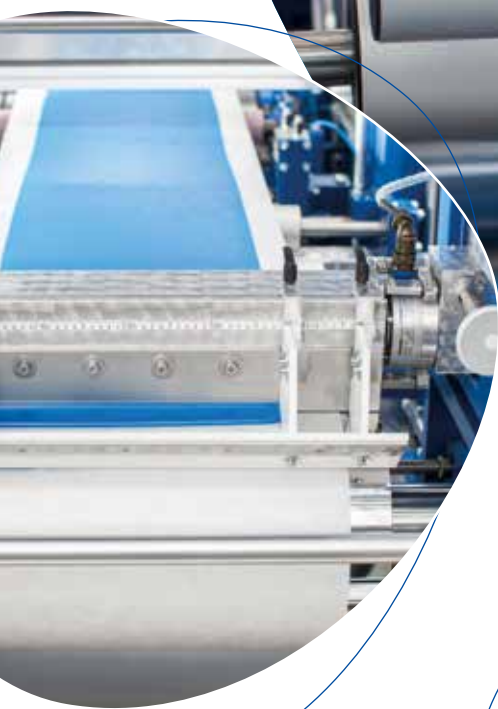
Beschichtungskopf mit optionaler Viskositätsmessung
