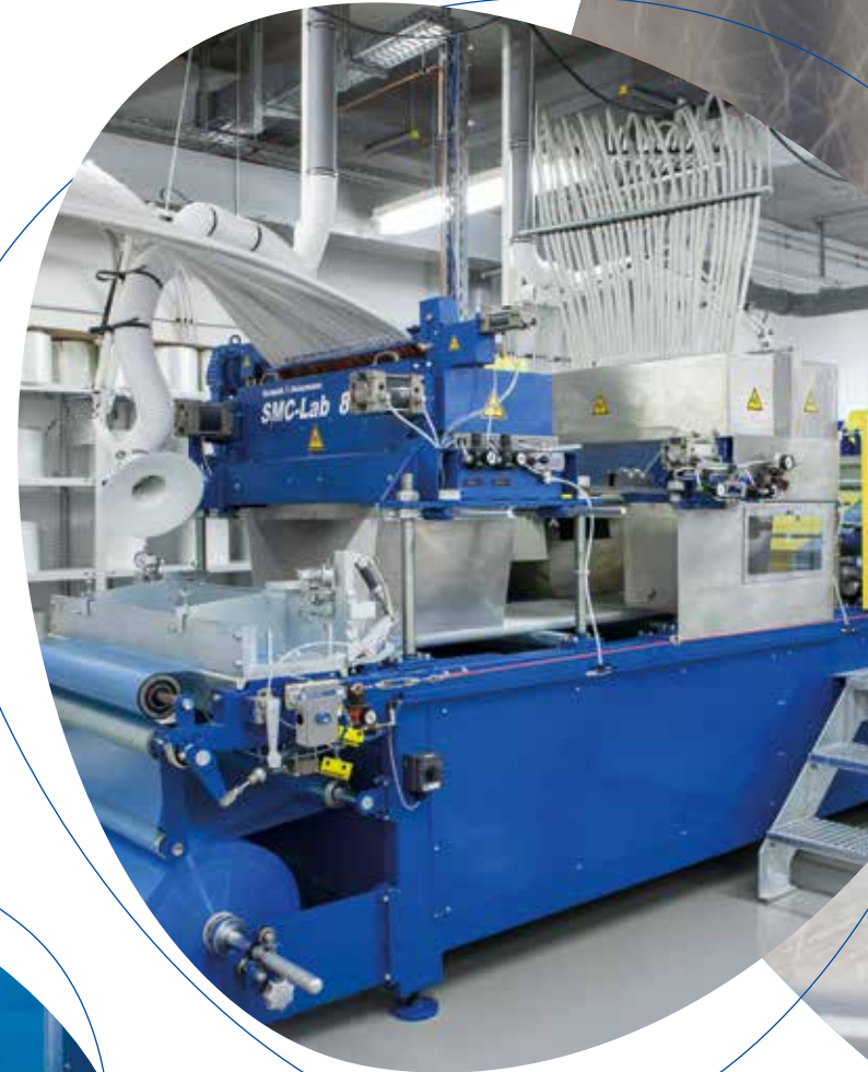
SMC-Anlage mit Glas- und Kohlefaserschneidwerk
