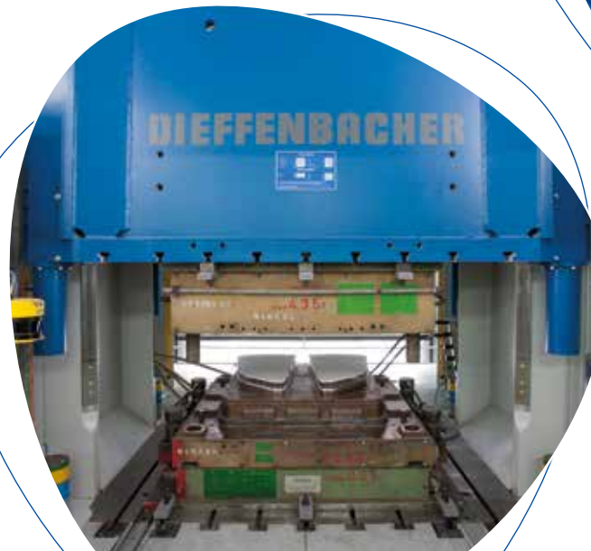
SMC-Pressen mit maximal 1.000 Tonnen Presskraft
