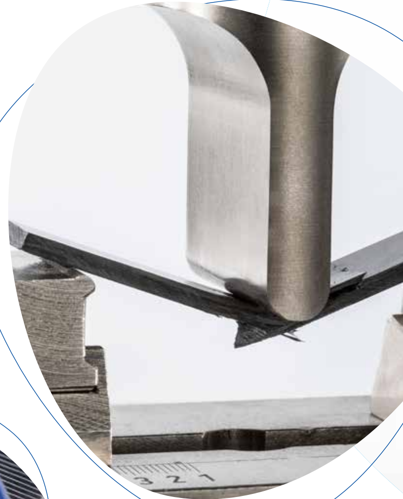
Biegeprüfung eines Probekörpers mit Carbonfasern
